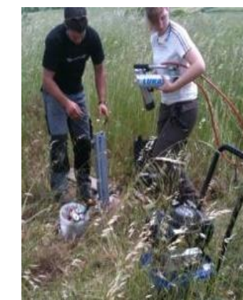
Photographie 9 : Test de résistance à l'arrachage des pieux
