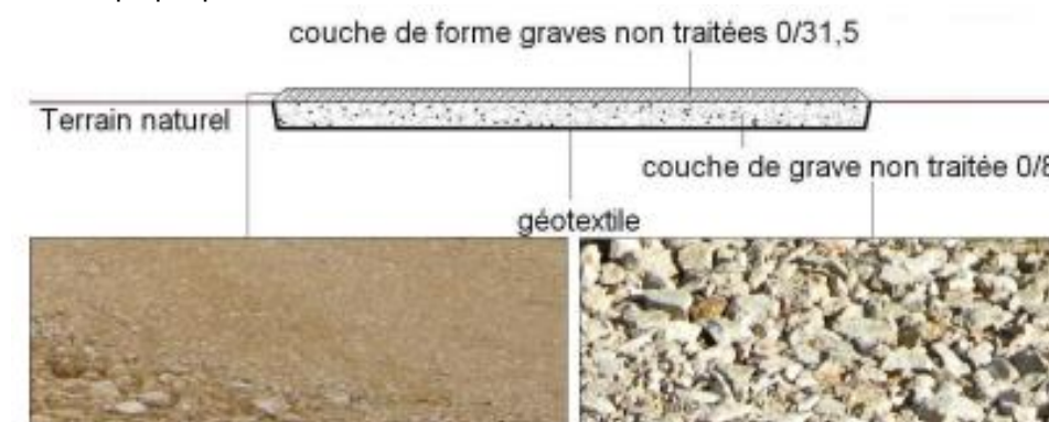
Figure 30 : Coupe de la voirie Plateforme de travaux
