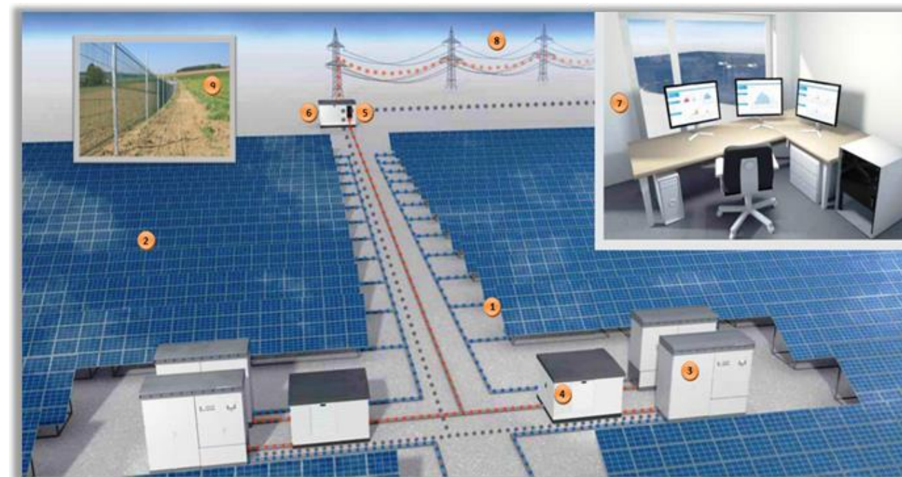
Figure 3 : Schéma de principe des composants d'un parc photovoltaïque au sol
